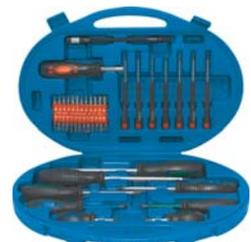
В наборе: 7 часовых отверток, 6 обычных отверток, 2 отвертки с изолированным жалом, отвертка с магнитным держателем бит, гибкое жало L=190 мм, 25 бит из хром-ванадиевой стали. Упаковка: пластиковый чемодан.
