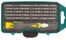
Для точных работ. В наборе: отвертка переставная для бит, биты: 30 шт. SL1.5, SL2, SL2.5, SL3; PH000, PH00, PH0, PH1, PH2; T4, T5, T6; Torx с отверстием: T7, T8, T9, T10, T15, T20; H1.5, H2, H2.5, H3, H4, H4.5; Y-тип Y0, Y1; U-тип U3; Pentalobe P0.8, P1.5, P2. Материал: хром-ванадиевая сталь, пластиковая прорезиненная ручка. Упаковка: пластиковый футляр.
