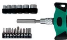
Профи. «WP». Для работы в труднодоступных местах. Реверсивный механизм, магнитный фиксатор бит, Т-образная прорезиненная ручка с кнопкой переключения реверса. В наборе: 9 бит из хром-ванадиевой стали (SL3; SL5; SL7; PH1; PH2; PH3; PZ1; PZ2; PZ3) + 6 головок (6, 7, 8, 9, 10, 11 мм) + адаптер для бит (75 мм, 1/4") + адаптер для головок (1/4").
