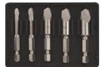
Экстракторы предназначены для выкручивания металлических шпилек и болтов с заломанными (сорванными) головками с классом прочности не более 8,8. Допустимый диаметр шпильки (болта) 7-18 мм. Шестигранный хвостовик. Материал: инструментальная сталь повышенной твердости. Упаковка: блистер.
