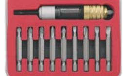
В наборе: магнитный адаптер для бит длиной 50 мм для закручивания шурупов на заданную глубину при производстве гипрочных работ, сборке упаковки; 9 бит (L=50 мм): SL4, SL5, SL6, PH1, PH2, PH3, PZ1, PZ2, PZ3. Материал: биты и механизм расцепления – сталь S2, ограничитель глубины из алюминия, держатель из инструментальной стали, хвостовик из хром-ванадиевой стали. Упаковка: пластиковая коробка в блистере.
