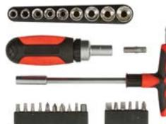
Для работы с крепежными элементами. В комплекте: биты L=25 мм (16 шт.) - PH0, PH1, PH2, PH3, PZ0, PZ1, PZ2, PZ3, SL4, SL5, SL6, SL7, T15, T20, T30, T35; переходник с биты на 1/4", L=25 мм; - Отвертка реверсивная, L=110 мм; - Т-образная отвертка с магнитным фиксатором для бит и присоединительным квадратом, 1/4"; - Головки 1/4": 5, 6, 7, 8, 9, 10, 11, 12, 13 мм (9 шт.); Материал: инструментальная сталь, биты из хром-ванадиевой стали, пластик, резина. Упаковка: блистер.
