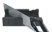
Для распиловки деталей шириной до 105 мм под углом. Вертикальные углы 45°/90°/135°, горизонтальный угол 45°. Зубья мелкие 13Т (шаг 2 мм). Материал: инструментальная сталь, пластик.
