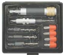
Сверла и биты с комбинированной насадкой и держателем. Для сверления отверстий и завинчивания крепежа. В комплекте: - сверла по дереву с зенкером: 2,5 мм (зенкер 9,5 мм), 3,0 мм (зенкер 9,5 мм), 3,2 мм (зенкер 9,5 мм), 3,5 мм (зенкер 11 мм); - 5 бит из стали S2 (25 мм): PZ1, PZ2, PH1, PH2, HEX4; - держатель с фиксатором и хвостовиком под биты с ключом HEX 2,5; - комбинированная насадка для сверл и бит. Материал: сталь S2, быстрорежущая сталь, алюминий. Упаковка: блистер.
