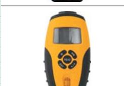
С лазерной указкой. Расчет площади, объема, измерение длины, определение текущей температуры (от 0°C до +40°C). Диапазон измерений: от 0,6 до 16 м. Автоматическое выключение. Автоматическое вычисление площади и объема комнаты. Функция запоминания и накопления полученных данных. Глазок уровня. Звуковая индикация. Подсветка дисплея. Источник питания: 1x9В (тип «Крона»). Материал: пластиковый корпус. Упаковка: блистер.
