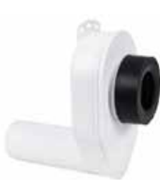
Сифон (трап) вакуумный HCUP50 для писсуаров с манжетным уплотнением, выход горизонтальный Артикул 9165
